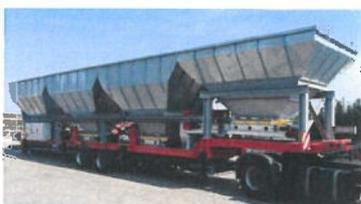
Hersteller von Gesteinskörnungen, die nicht über eine Siloanlage mit Dosierorganen verfügen, sind in ihrer Angebotsbreite limitiert. Dabei wäre der Verkauf spezieller Körnungsprodukte durchaus attraktiv. Möglich wird er mit Hilfe mobiler Reihen-Dosieranlagen aus dem aktuell erweiterten Programm der Moerschen GmbH.
